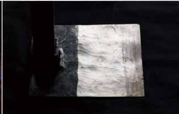
つつ刃の上にわら束を置いて燃やし、鋼鑄物が溶けた時点で窯から出して、わらの燃えかすを叩きつけてながら刃先を鍛えていきます。こうするとわらが燃える熱で刃の表面の温度が一気に上がり、溶けた鋼鑄物が刃先の表面に被膜のように均一に広がり、薄くても強い刃に仕上がるのです。
