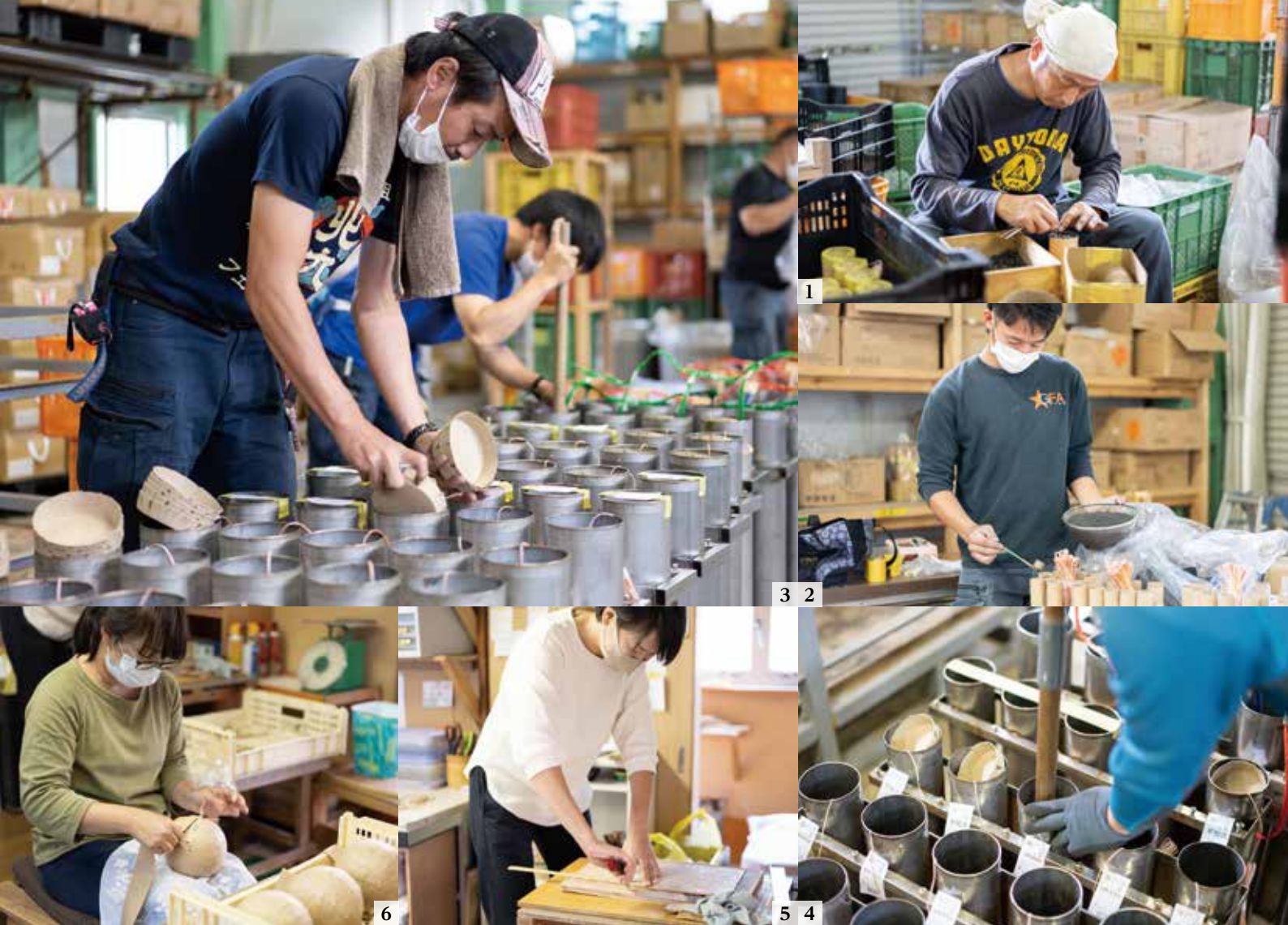
1.2.玉込めの様子／3.4.打上げ筒に花火玉を入れる／5.花火玉に貼るクラフト紙を均一にカット／6.玉貼り作業。花火玉にクラフト紙を貼り重ねていく
