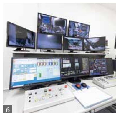
1.太宰府市内に新設した次世代型生コンプラント／2.プラント最上階から残コン・戻りコンが分別されながら落下していく／3.残コン・戻りコンから分離した再利用可能な骨材／4.浄化された水も再利用されるが、この水が階下に落ちる際に発電機のモーターを回す／5.明るくクリーンな桂川工場の内部／6.バッチャープラント制御盤FX-Vでさらに業務を効率化／7.ヘドロに中性固化材を投入して混ぜると瞬時に固化する
