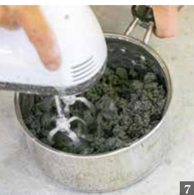
1.太宰府市内に新設した次世代型生コンプラント／2.プラント最上階から残コン・戻りコンが分別されながら落下していく／3.残コン・戻りコンから分離した再利用可能な骨材／4.浄化された水も再利用されるが、この水が階下に落ちる際に発電機のモーターを回す／5.明るくクリーンな桂川工場の内部／6.バッチャープラント制御盤FX-Vでさらに業務を効率化／7.ヘドロに中性固化材を投入して混ぜると瞬時に固化する
