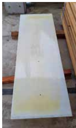
プラスチック製の軽量素材(カタパネル)
