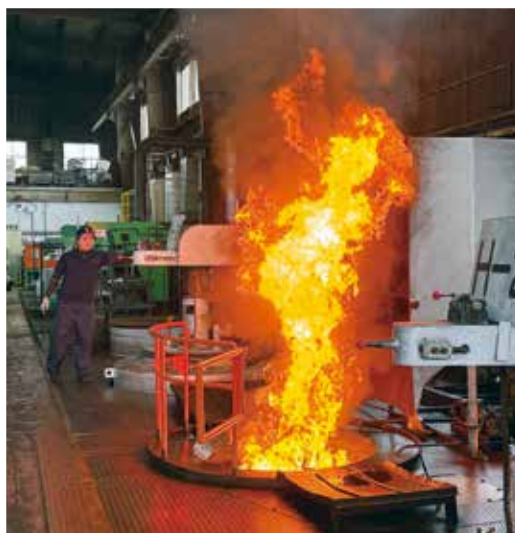
熱処理第一工場内 左.ピット型焼入炉／右.中性塩浴炉 創業から現在も稼働中のソルトバス(ひとつの炉で創業)
