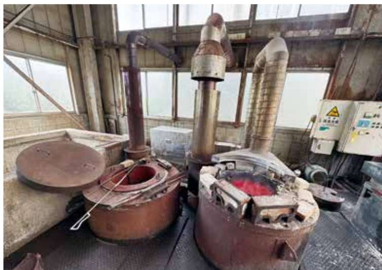
熱処理第一工場内 左.ピット型焼入炉／右.中性塩浴炉 創業から現在も稼働中のソルトバス(ひとつの炉で創業)
