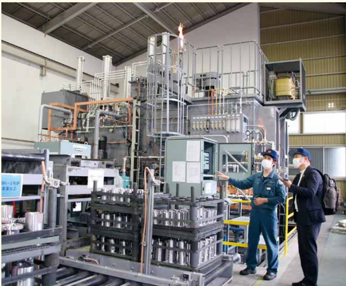
熱処理第二工場 「無人監視システム付パッチ型光輝多目的熱処理炉」前にて取材
