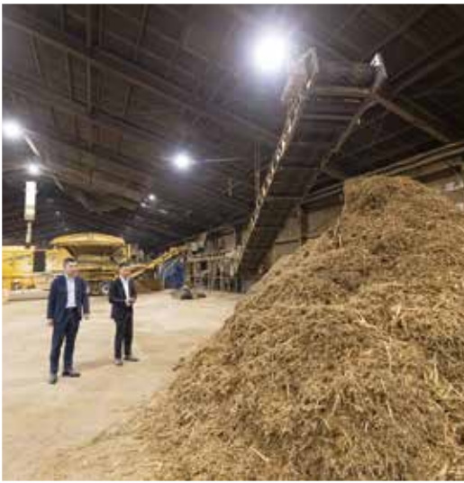
集められた樹木・剪定枝(生木)は破砕機で粉碎される
