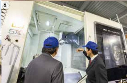
1.対談風景/2.3.主力製品である青銅製バルブの説明を受ける/4.製品重量は約60kgに及ぶ/5.6. 鋳造工程「出湯」を見学。凄まじい高温で素人は近寄ることは出来ない/7.(株)TCAST第2工場前にて記念撮影/8.高性能を誇る5軸制御マシニングセンタ/9.外部パートナーである(株)オートマイズ・ラボ研究開発製品「オートマイザー(後付け電動駆動装置)」の前に/10.隣接する新工場建設予定地。写真奥は社名の由来となった鷹取山(耳納連山)/11.企業メッセージ
