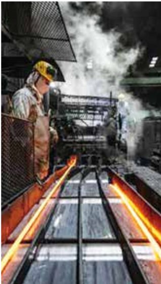
熱間圧延による鉄筋製造
