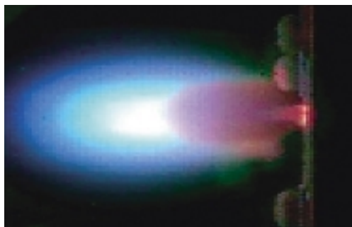
(図1) パルスレーザーデポジション(PLD)法 ターゲットと呼ばれる薄膜のもとに高エネルギーのレーザーを当てると、固体が瞬時に気体になりさらに電離して図のようなプラズマとなります。これを利用して薄膜を作ります。
