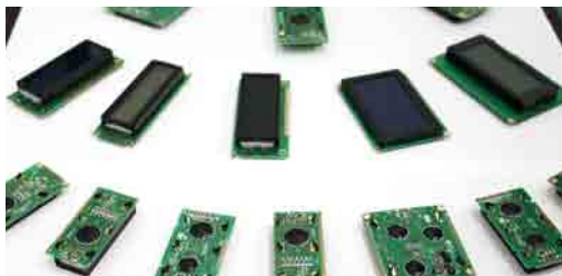
▲LCM(電子部品)。産業用機器や医療機器のディスプレイ等に用いる部品。
