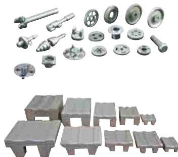
▲熱間鍛造品。強度が高く、材料の無駄が少ないためコストが低い特徴がある。
