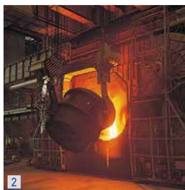
1.戸畑第四高炉 高炉下にはトーベードカー（搬送用車輦）が銑鉄を待つ 2.転炉 不純物を取り除き、高品質な鋼に変わる 3.熱延工場内の様子 4.連続熱間圧延 複数の大型ローラーがスラブを薄い鋼板に伸ばしていく 5.棒鋼 ビレットを圧延して棒鋼を作る 6.線材 コイル状にて出荷される (2、5、6 新日鐵住金株式会社 八幡製鐵所 所蔵)
