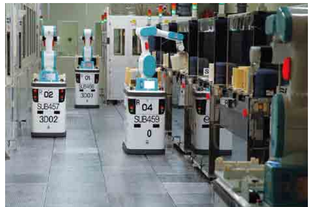
▲熊本川尻工場クリーンルーム内の様子（作業を行う搬送ロボット）
