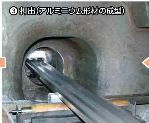
③ 押出(アルミニウム形材の成型)
