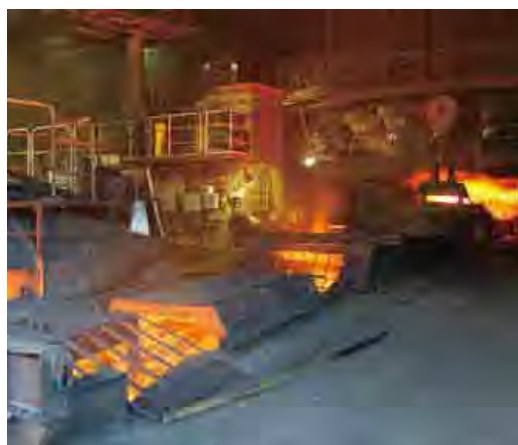
▲製鉄所内で樋を流れる鉄
