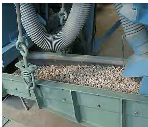
▲原料の圧縮・破碎工程
