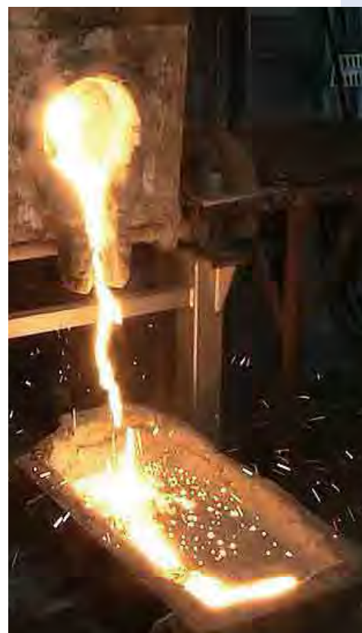
▲溶かした鉄を受け止める耐火物
