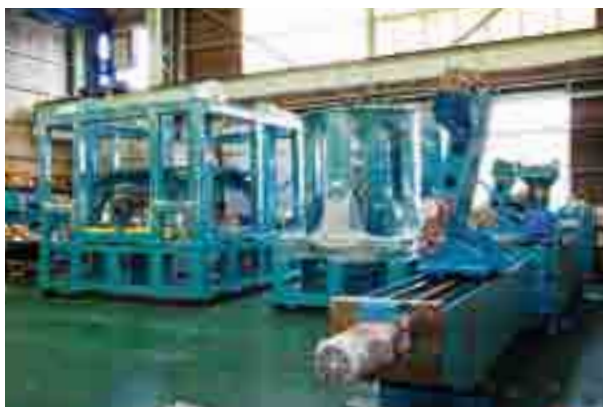
▲当社が手掛ける製品の例②シリコンインゴット引き上げ装置
