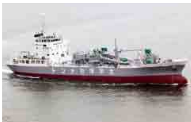
▲電気推進式セメント運搬船
