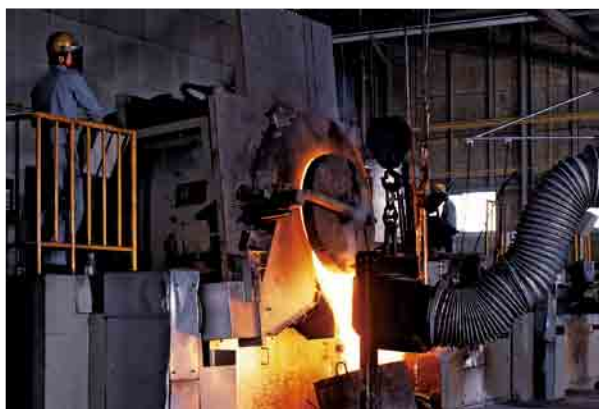
▲次工程に向け注ぎ込まれる赤々と溶けた鉄
