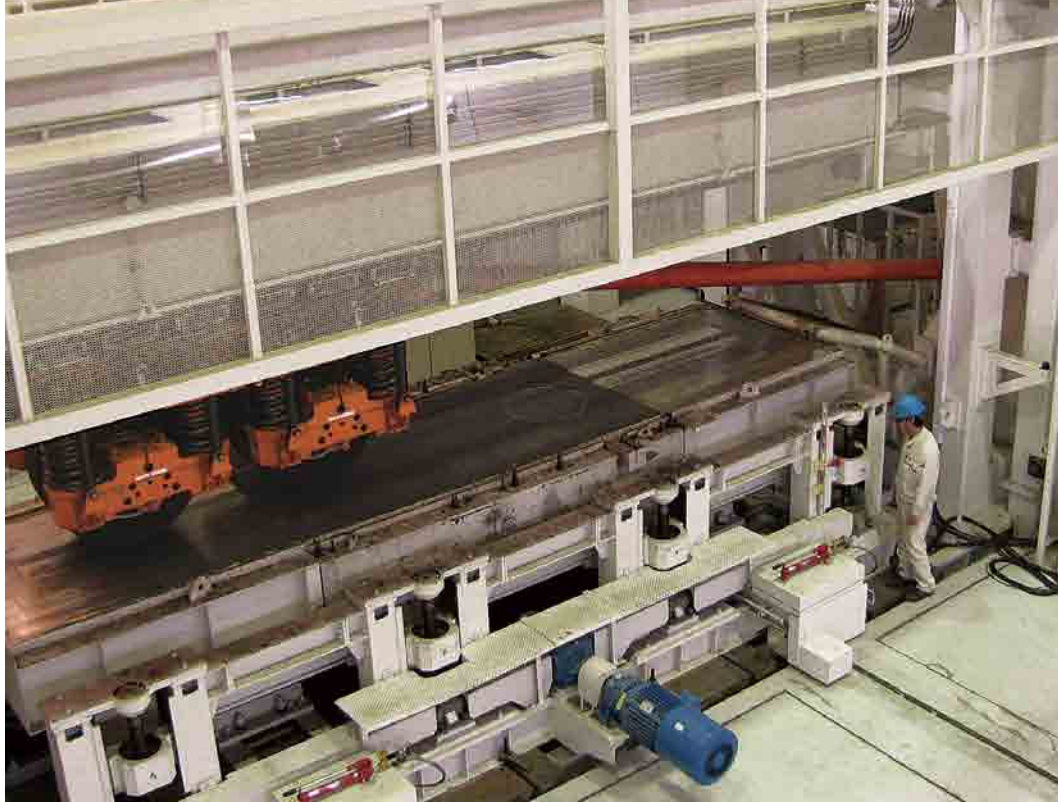
▲G&U技術研究センター - 輪荷重走行試験機
