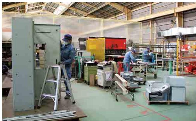
▲薄板から打ち出された部材と製缶後、組立中の制御盤
