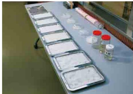
▲押し出しラミネートで使用するポリエチレン原料
