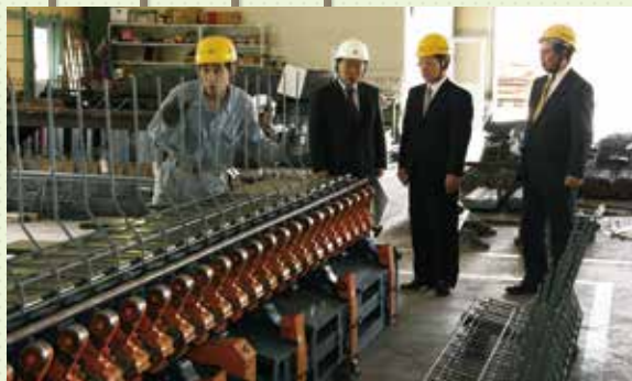
▲ユニット鉄筋曲げ工程
