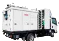
▲トンネル点検車両「MIMM」
