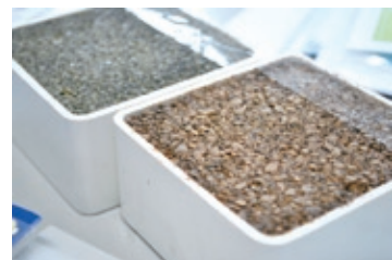
島谷先生が推薦した透水ブロック。クッション性があるので歩きやすい。内部の微細な隙間に水が浸透することで夏は涼しく冬は暖かいという効果も。
