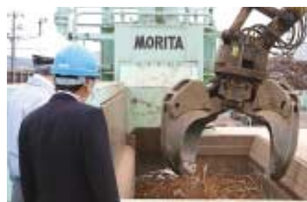
ギロチンへの鉄屑投入の様子
